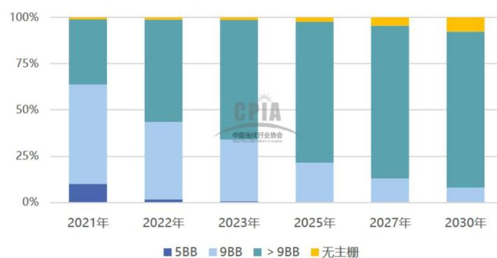
多主栅技术下常规焊带的性能已不足够，线径更细的 MBB 焊带应运而生。到了 Topcn 和异质结技术时代，由于银浆消耗量较 PERC 增加了 20%-30%，所以把焊带升级为 SMBB 焊带。MBB 焊带直径已缩窄至 0.2-0.4mm 之
