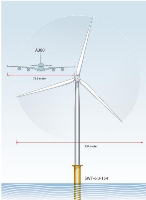
由于风机的大型化趋势，叶片受到的制约也越来越多，对于材料、性能、气动、结构设计以及制作工艺的要求越来越高，同时还需保持低成本，而叶片成本在风机整机中占比最大，约为 20%，这对于研发团队提出了更高的要求。未来的风电叶片需要钢度大、强度高、轻量化发展，来适应大型化风机、更强的风速以及更恶劣的环境，如风沙、腐蚀等。
