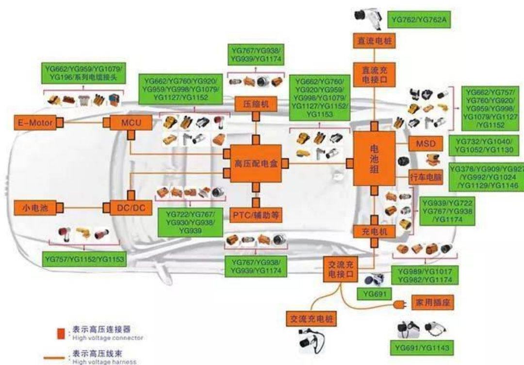
图 9 高压连接器在整车系统中布局
