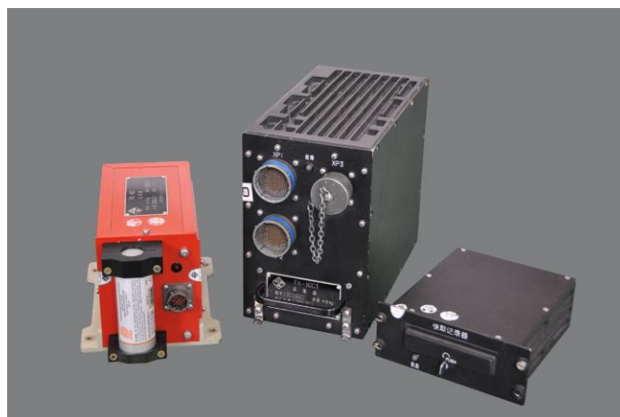
图 25 飞行参数采集记录系统
