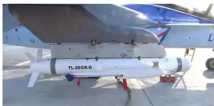
图 16 TL20 空对地小直径制导炸弹
