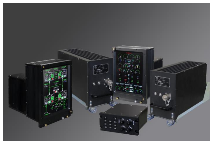
图 26 发动机指示和空勤告警系统
