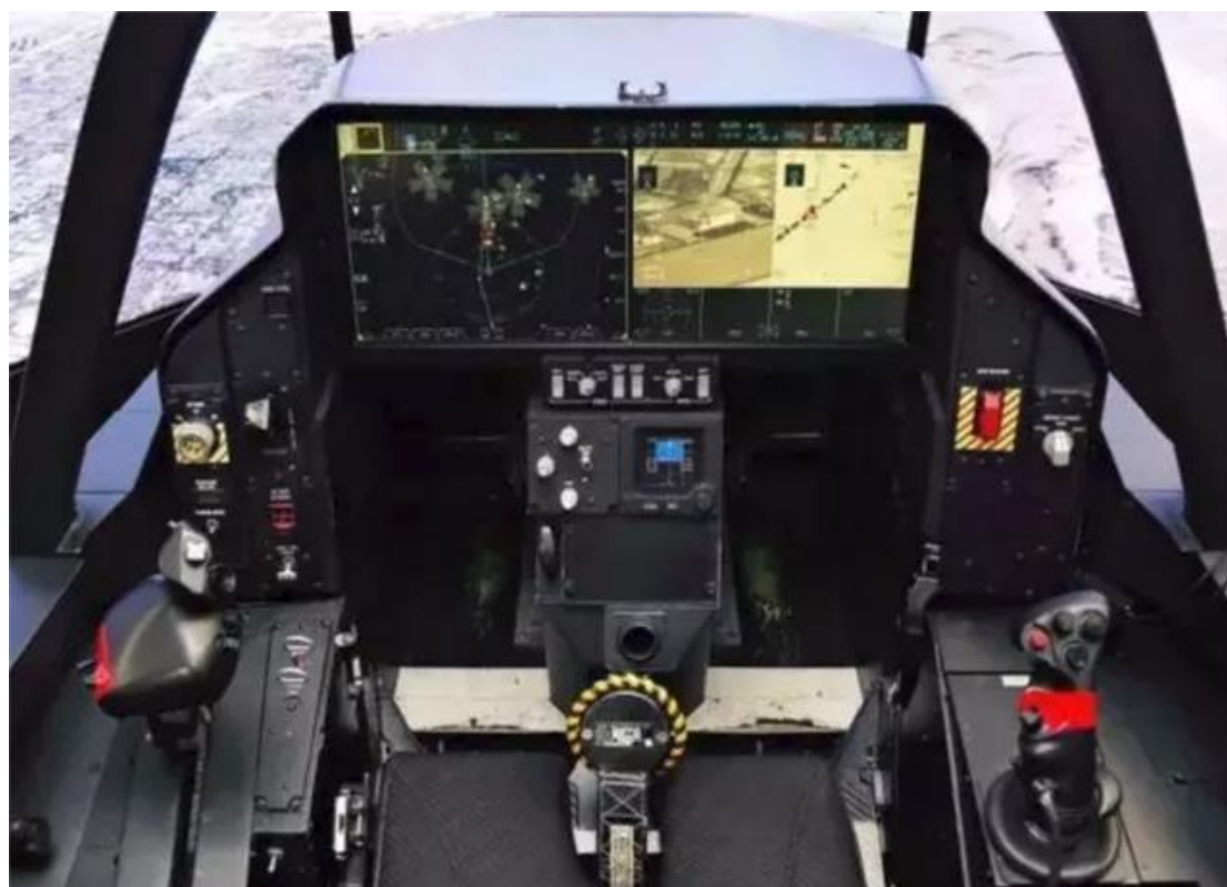
图 24 F35 先进座舱显示系统
