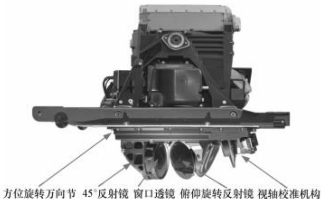
图 36 光电瞄准系统 EOTS 内部结构
