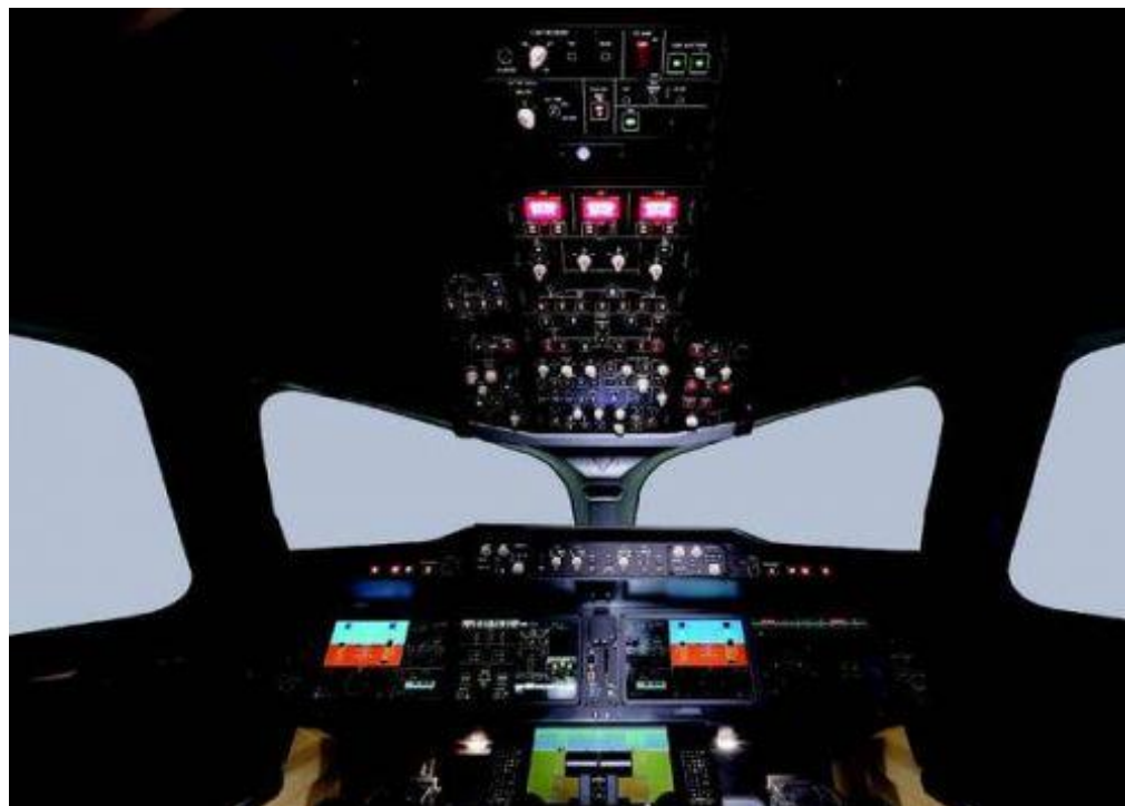
图 23 C919 飞机 CPA&amp;DCS 实物图
